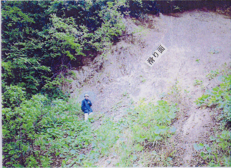
図-4-16 ⑥の地すべりのCの領域に見られる滑り面
