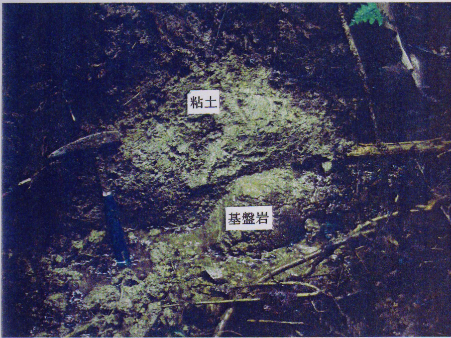
図-4-1 ①の初期的変形地形の下底部の地すべり粘土層
