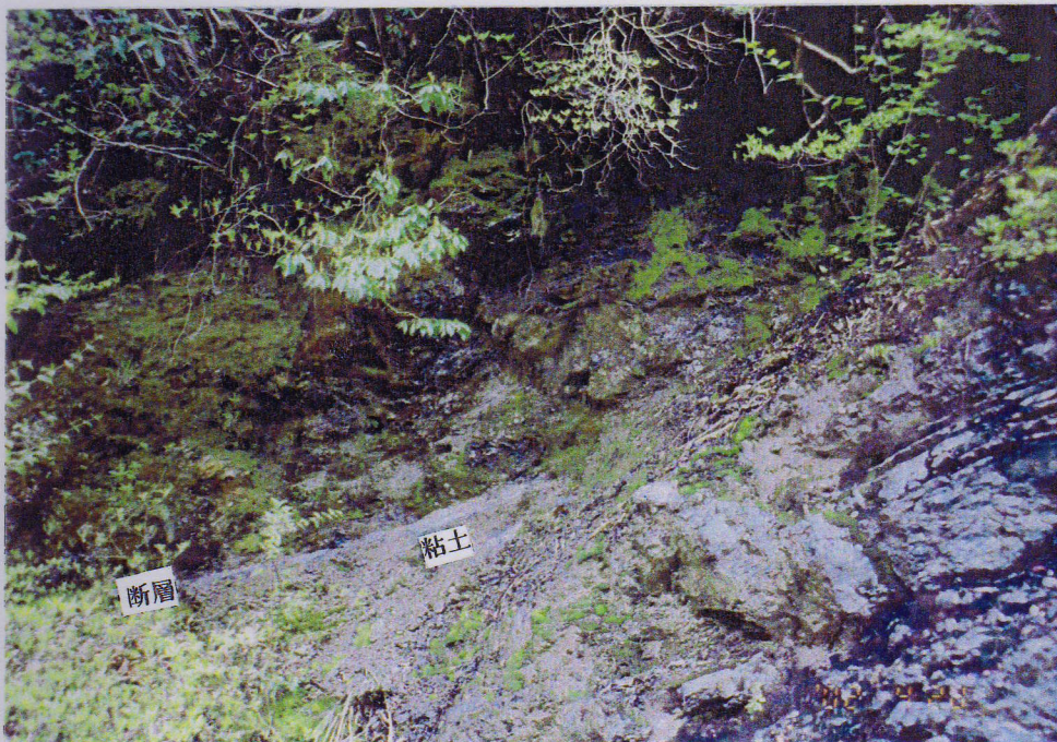
図-4-2 ①の初期的変形地形直下のチャートの弛み 低角度断層が発達
